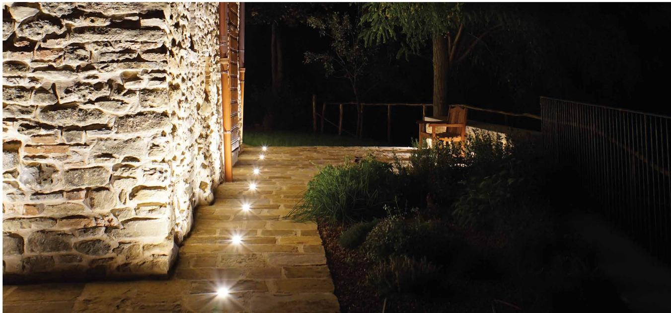
Incasto tornito in acciaio 304 con LED di potenza per illuminazione decorativa o segna passo. Diffusione radiale anti abbagliamento, installabile in ambienti interni ed esterni. Montaggio con cassaforma per muratura.
